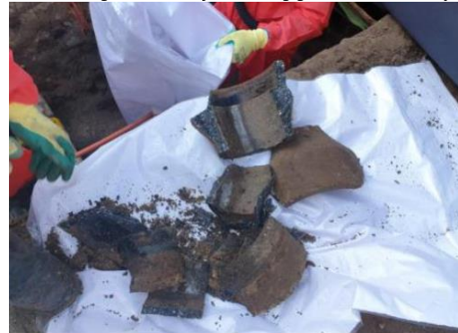
Foto 31: Uitsneden mofverbinding gebroken met vuistje
